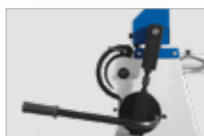
Klemmhebel mit Federunterstützung
